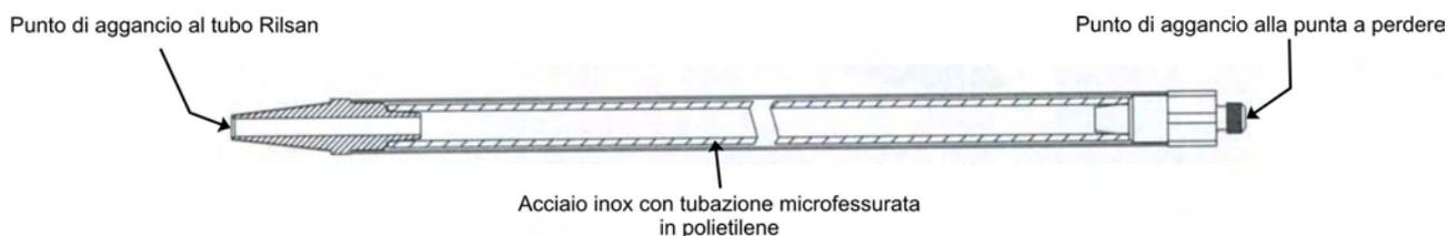
Il sistema costituito dal collegamento del tubo Rilsan con l'impianto Air Sparging viene calato all'interno della batteria di aste e, al raggiungimento della profondità di base della perforazione, viene agganciato alla punta a perdere.
