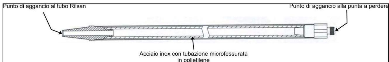
**Figura 2-1 – Schema diffusore**
